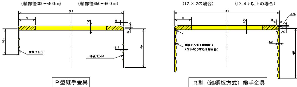
※上杭の頭部端板のみ、16mm～40mmの範囲で変更できる。
